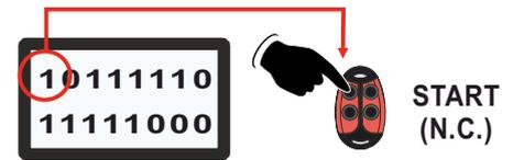
● Exemple: si la photocellule est activée, sur l'écran l'entrée change de normalement fermée à normalement ouverte
