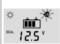
Le symbole *low battery* qui clignote indique que la protection contre la batterie déchargée est intervenue et que, pour préserver la vie de la batterie, la charge a donc été déconnectée. Cette protection intervient lorsque la tension de la batterie descend sous le seuil  $V_{LB}$  configurable par l'utilisateur (Tab.2). Le dispositif ESUN PLUS BOOST quitte cette protection lorsque la batterie sera rechargée par le module PV à la tension  $V_{elb}$  configurable.
