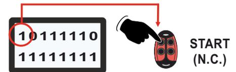
● Exemple: si la photocellule est activée, sur l'écran l'entrée change de normalement fermée à normalement ouverte
