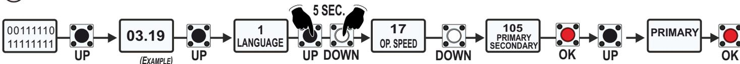
7 MOTOR 2 CONTROL UNIT «SECONDARY» SET UP
